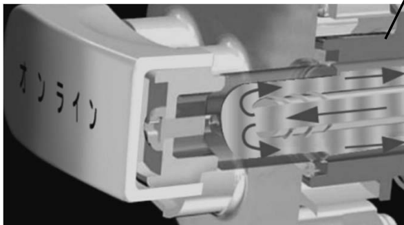
図3 透析監視装置NCV-3の ヒートピュア機能(オンラインポート部)
