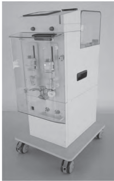
装置前面：採液シリンジポンプ×2機
