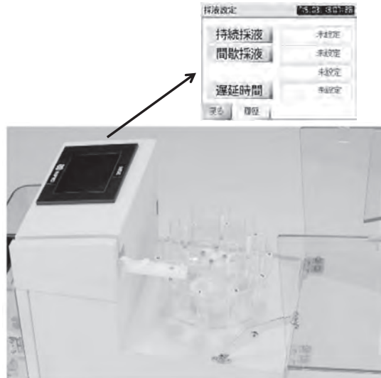
装置上部：操作パネル 貯留スピッツのターンテーブル
